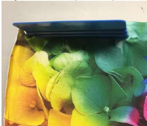
5. Repita el paso 4 a lo largo de los lados y la base. Agregue suficiente tensión para que el grafico quede plano. Agregar demasiada tensión puede distorsionar el grafico. Meta el exceso de tela en el marco para completar la apariencia final.
