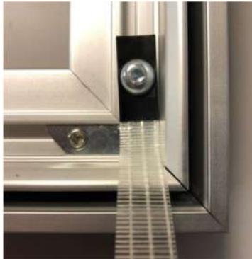
4. Comenzando en una de las esquinas superiores con un squeegee u otra herramienta adecuada, coloque el squeegee en la línea. Empuje el squeegee y la tela en la ranura de la sección superior del marco cerca de la esquina. Repita en la esquina opuesta. Antes de presionar la tela en el marco, asegúrese de que esté alineada y recta. Empuje la tela a lo largo de la línea a lo largo del marco superior. Manteniéndolo alineado y recto en la parte superior.
