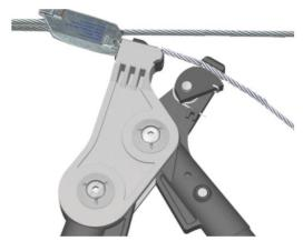
2. Posicione la boquilla de la herramienta contra el candado tensor, y agarre el cable sobrante con la leva.
