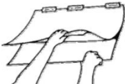
**Paso 4.** Retire el respaldo y rocíe la superficie con Splash.
