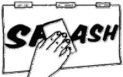
**Paso 6.** Espere dos minutos y retire la cinta de transferencia tirando hacia abajo en un ángulo de 45°.
