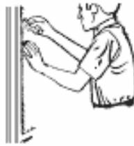
8. Revisar que no queden burbujas y en el caso de que si volver a presionar con el squeegee para eliminarlas.
