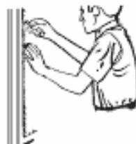
8. Revisar que no queden burbujas y en el caso de que si volver a presionar con el squeegee para eliminarlas.
