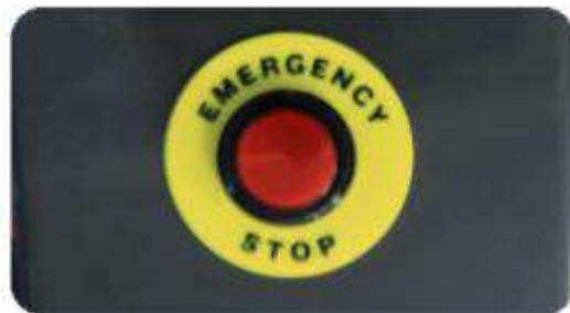
**Interruptor de parada de emergencia:** en caso de emergencia, el usuario puede presionar este interruptor para detener la operación.
