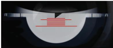
Extender cuchilla un poco mas del grosor del material si se realiza **PERF CUT** y un poco menos si se realiza **KISS CUT**
