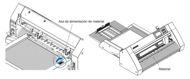
2. Ajuste la posición del rodillo de empuje de manera que la distancia entre el borde del material y el borde del rodillo de empuje sea de 5 mm.
