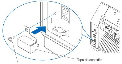
Tornillo de montaje para la tapa de conexión del ASF1-30
