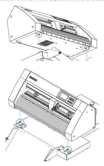
2. Después de instalar el CE8000-40, presione el CE8000-40 en la dirección de la flecha en la figura siguiente.
