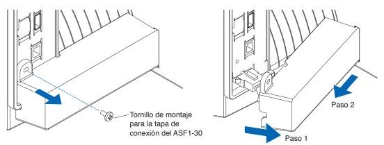
3. Retire el cable de conexión.
