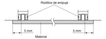
**3.** Después de ajustar la posición del rodillo de empuje, gire el asa de alimentación de material para expulsar el material.
