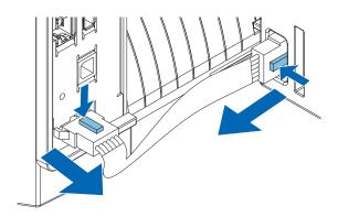
4. Levante el ganchos de fijación del ASF1-30 y, a continuación, extraiga el ASF1-30 hacia la parte trasera.
