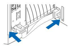
4. Coloque la cubierta del cable. Inserte la cubierta del cable en la muesca del ASF1-30 y fíjela al CE8000-40 utilizando el tornillo de fijación de la cubierta de conexión.
