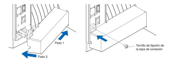
Inserte la bandeja de extensión.Al insertar la bandeja de extensión, asegúrese de que no haya nada debajo de ella.Si hay algo debajo de la bandeja de extensión, el material no se introducirá correctamente.
