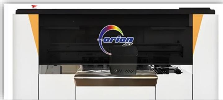
El equipo FD-A30 con un ancho de trabajo de 30 cm no necesita grabado, ni alguna placa hueca hacia fuera, el equipo es fácil de utilizar y cuenta con un software muy amigable para la operación del mismo (MAINTOP, FLEXIPRINT). Además, el equipo cuenta con tinta pigmentada a base agua, y con el par de cabezales XP600 el equipo FD30, nos ofrece una velocidad de 4m<sup>2</sup>/hr a 6 pasadas
